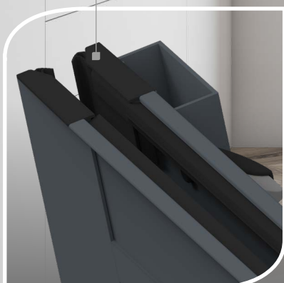
Montant renforcé pour lutter contre l'effet bilame
